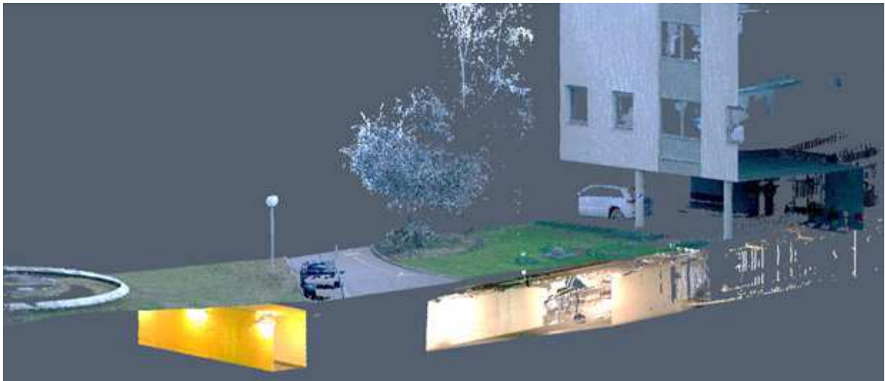
Anhand der 3D-Punktwolke werden die Zusammenhänge zwischen Korridoren, Terrain und Gebäuden ersichtlich.
