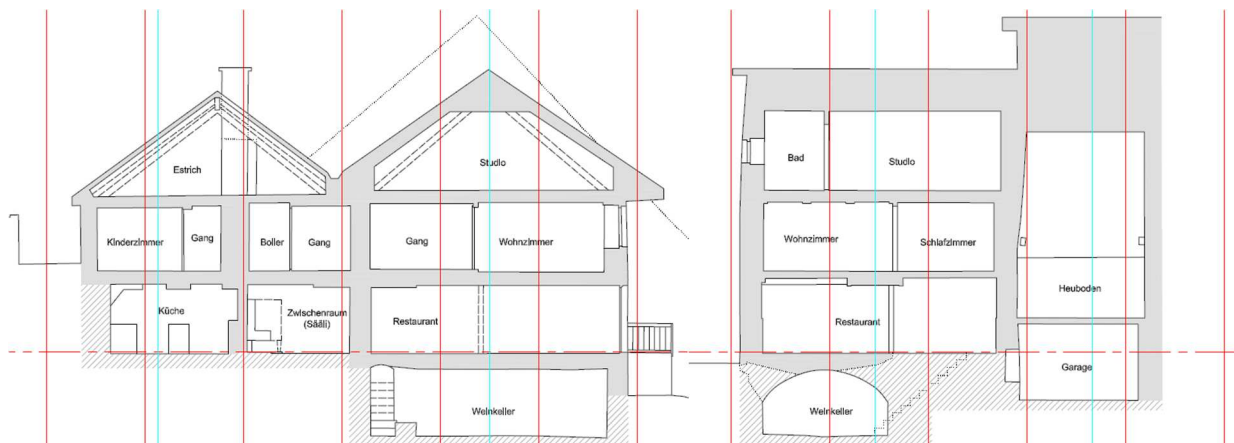
Quer- und Längsschnitt eines alten Wohngebäudes; Wand- und Bodenstärken sind an beliebigen Stellen messbar.
