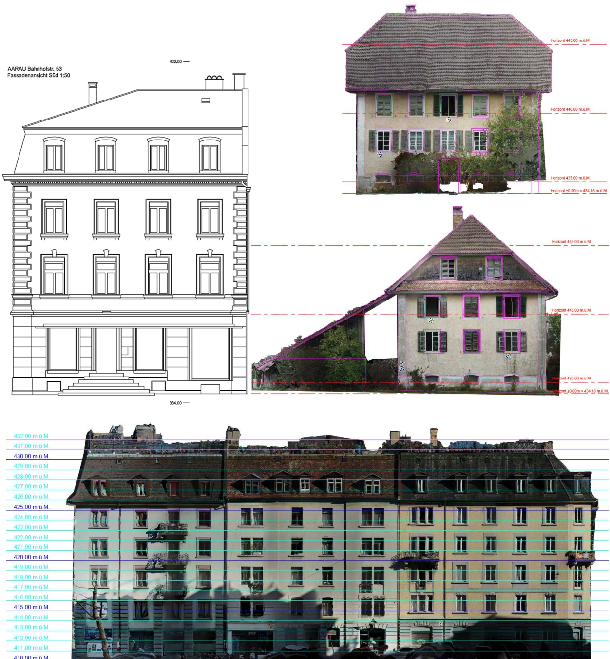
Verschiedene Varianten von Fassadenplänen: detaillierte Strichzeichnung und fotorealistische Ansichten.
